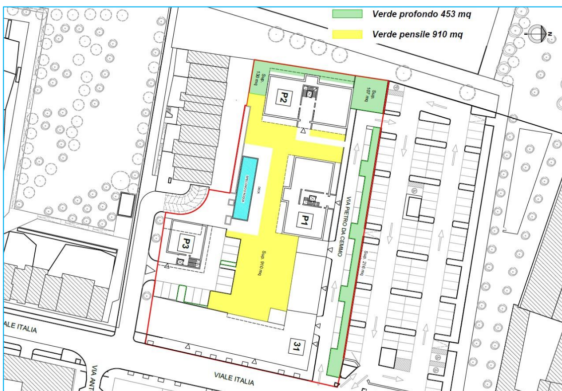
Fig. 21 – Miniatura estratta dalla tavola di progetto che mostra la superficie a verde profondo di progetto pari a 453 mq. Rispetto al verde profondo ante-operam si ha un bilancio positivo con aumento di 31mq a cui va aggiunto il valore ecologico del verde pensile dotato di prati stabili con arbusti e alberi che passa da zero mq a ben 910 mq. In conclusione è possibile affermare che il bilancio del consumo di suolo è favorevole sia nella superficie profonda che in quella rinverdita con prato e nuove piante che passa dai 12 ligustri malposizionati in cordolo a centinaia di arbusti e 31 nuovi alberi in terreno inerbito.
