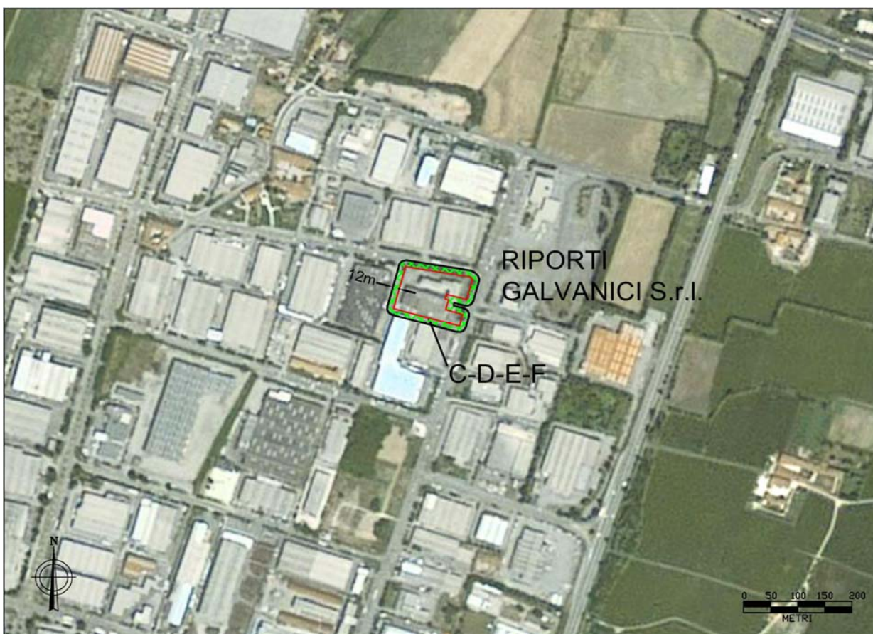
Figura 10. 2: Confini dello stabilimento Riporti Galvanici S.r.l. e distanze di danno.
