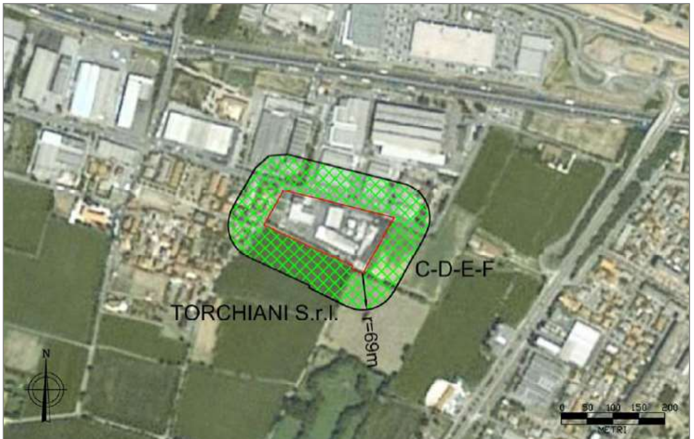
Immagine: Figura 11.3 Confini dello stabilimento Torchiani S.r.l. e distanze di danno (fonte: PGT di Brescia – AL1102)
