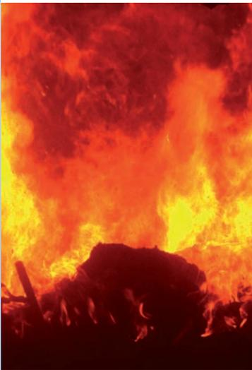
La combustione delle parti solide avviene sulla griglia, dove la temperatura della fiamma viene automaticamente regolata al valore di circa 1100°C, così da distruggere i componenti organici presenti nei rifiuti e, nel contempo, ridurre la formazione di Ossidi di Azoto e Monossido di Carbonio.
