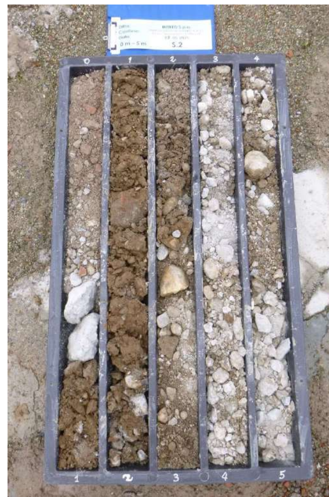
Foto n.9– Sondaggio S.2 0,0 m – 5,0 m
