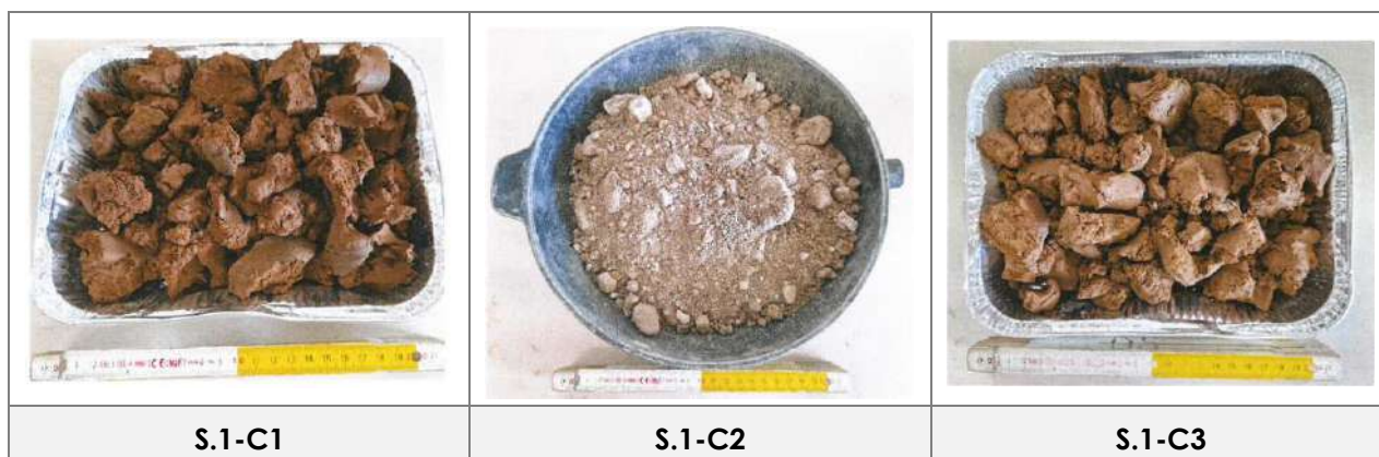
Figura 13: Foto dei campioni prelevati dal Sondaggio S.1
