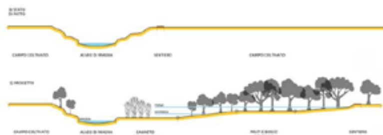
Figura 4. Sezioni indicative di possibili interventi di ampliamento dello spazio fluviale e rivitalizzazione del fiume
