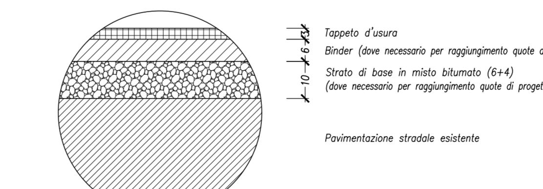
\*\* previa fresatura/scarifica pavimentazione esistente minimo cm 3
