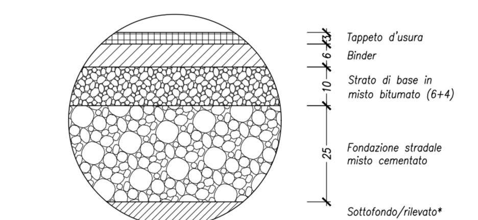
\* sul piano di posa della fondazione stradale di nuova realizzazione dovrà ottenersi un modulo di compressibilità Me definito dalle norme svizzere (SNV670317) di valore non inferiore a 80 N/mm², misurato in condizioni umidità prossime a quelle di costipamento, al primo ciclo di carico e nell'intervallo compreso tra 0,15 N/mm² e 0,25 N/mm². Sulla strato di fondazione stradale di nuova realizzazione il valore del modulo di cui sopra non dovrà essere inferiore a 100 N/mm².
