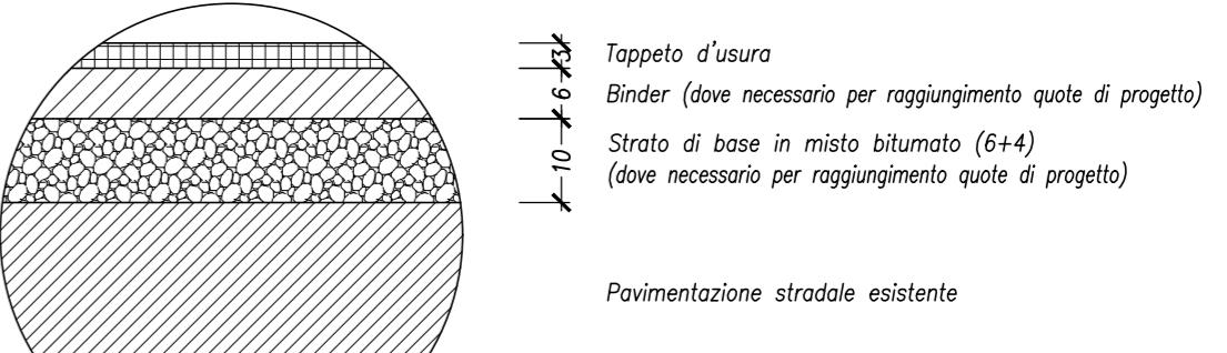
\*\* previa fresatura/scarifica pavimentazione esistente minimo cm 3
