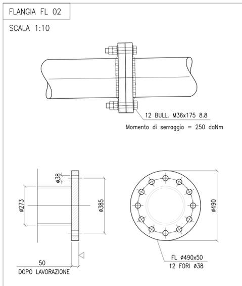
N.B. : DOPO IL SERRAGGIO SIGILLARE TESTE BULLONI CON VERNICIATURA COME DA CICLO, VERNICIANDO A SATURAZIONE I BORDI DEI PEZZI A CONTATTO, LE ROSETTE, LE TESTE ED I DADI DEI BULLONI, IN MODO DA IMPEDIRE QUALSIASI INFILTRAZIONE ALL'INTERNO DEL GIUNTO.
