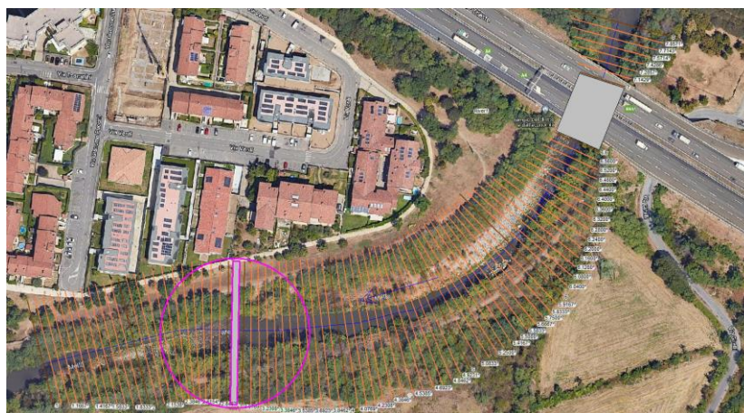
Fig. 8 – Schema idraulico del tratto verificato con modello Hec-Ras (sezioni interpolate per il calcolo)
