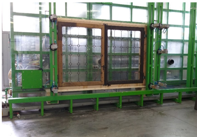
SERRAMENTO IN LABORATORIO – PROVE DI TENUTA
