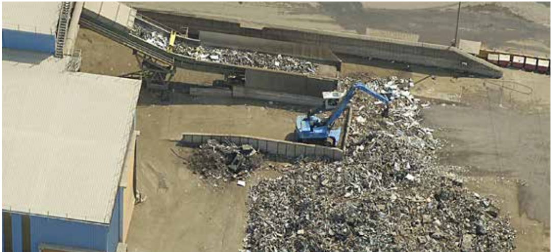
Rottame in fase di caricamento al frantumatore
