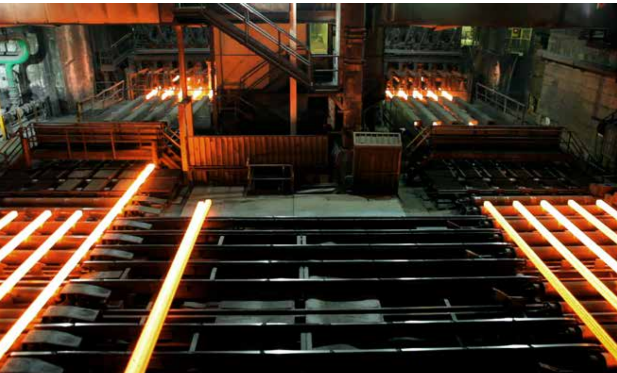
Macchine da colata continua
