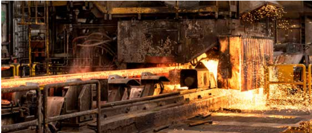
Linea laminazione a caldo per lavorazione delle billette
