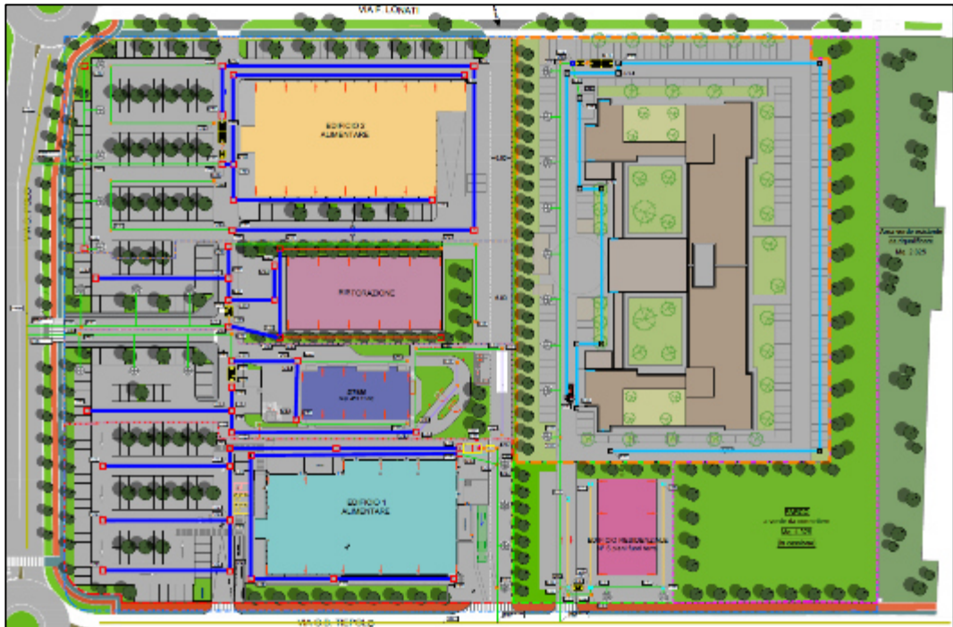
Figura 16. Planimetria della rete di acque meteoriche stato di progetto
