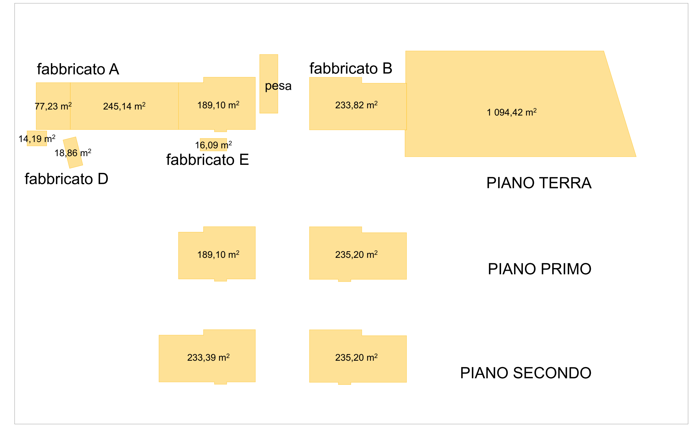
EDIFICI ESISTENTI VERIFICA SLP IN DEMOLIZIONE
