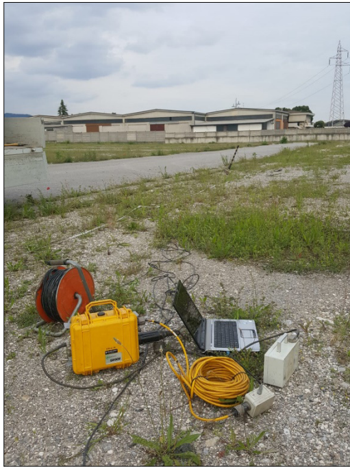
Acquisizione dei segnali sismici mediante sismografo Geometrics
