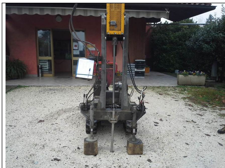
Prova penetrometrica SCPT 3
