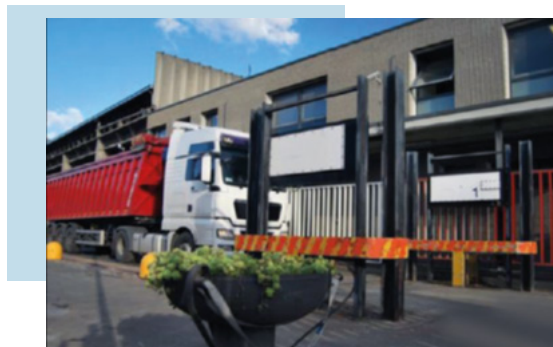
Rilevatori di radioattività all'ingresso dello stabilimento
