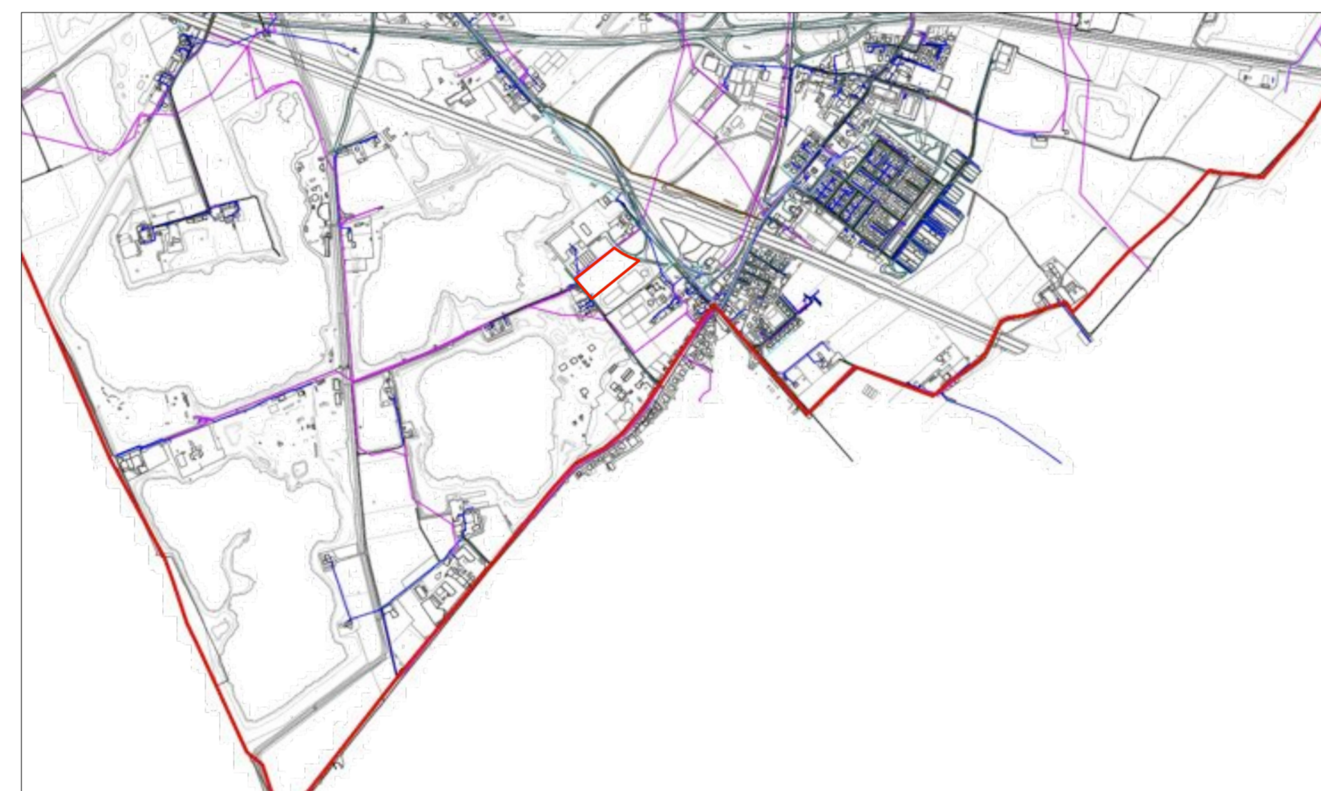
PRG_Piano dei Servizi_PR06 P.U.G.S.S. servizi sotsuolo esistenti 1:15.000
