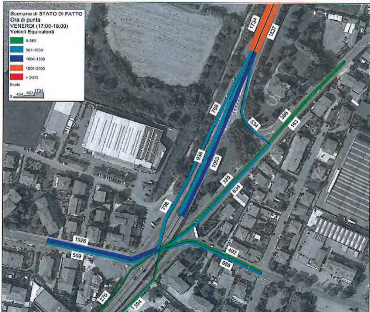
Figura 5: veicoli equivalenti nell'ora di punta (fonte: Analisi Impatto viabilistico allegato al PA9)
