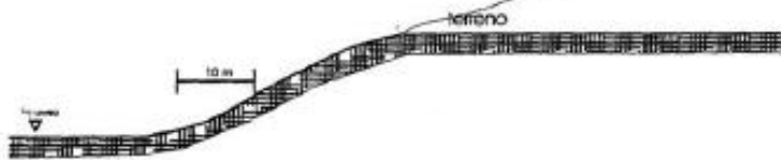
SEZIONE TIPO: argine in terreno naturale, la distanza è da intendersi dalla linea di massima piena (TR = 100 anni)
