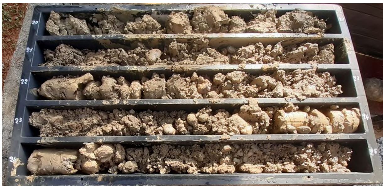
Immagine delle cassette catalogatrici – Sondaggio S2 da -20 a -25m
