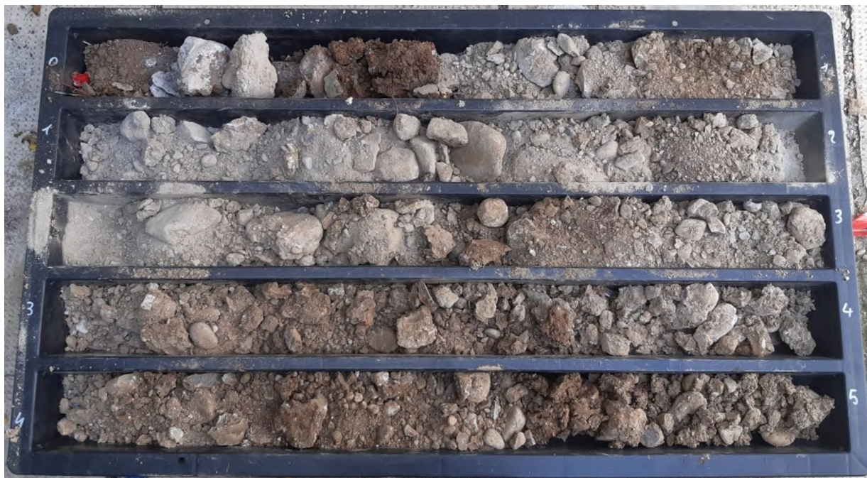
Immagine delle cassette catalogatrici – Sondaggio S1 da 0 a -5m
