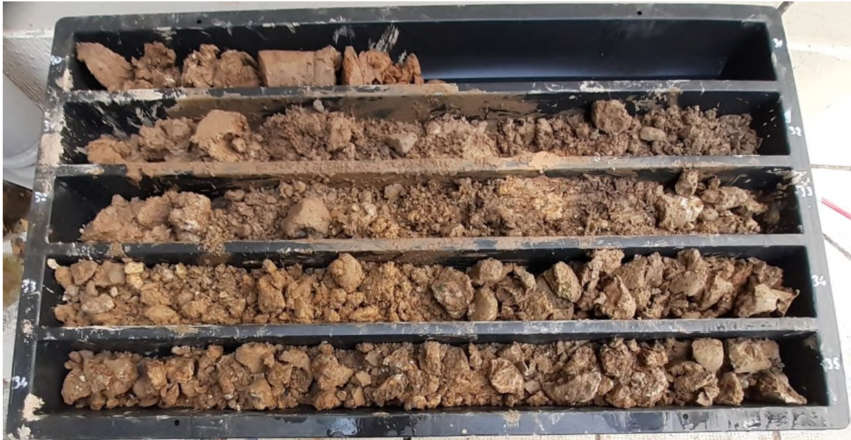
Immagine delle cassette catalogatrici – Sondaggio S1 da -30 a -35m
