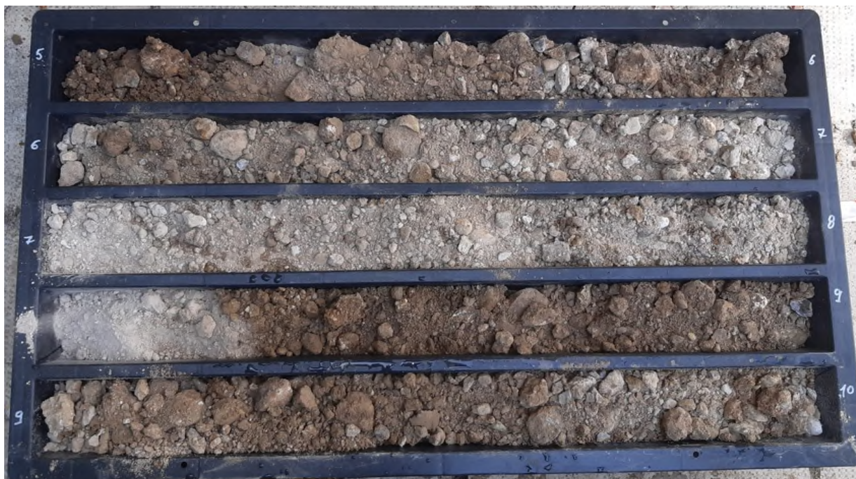
Immagine delle cassette catalogatrici – Sondaggio S1 da -5 a -10m
