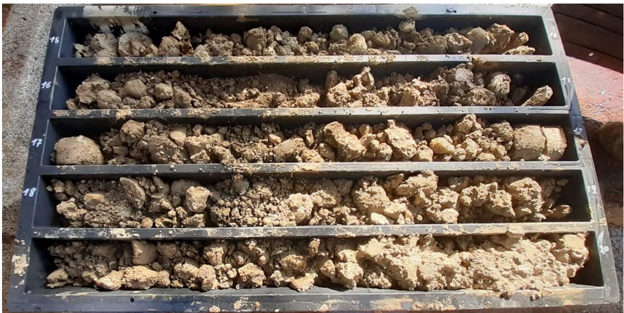
Immagine delle cassette catalogatrici – Sondaggio S2 da -15 a -20m
