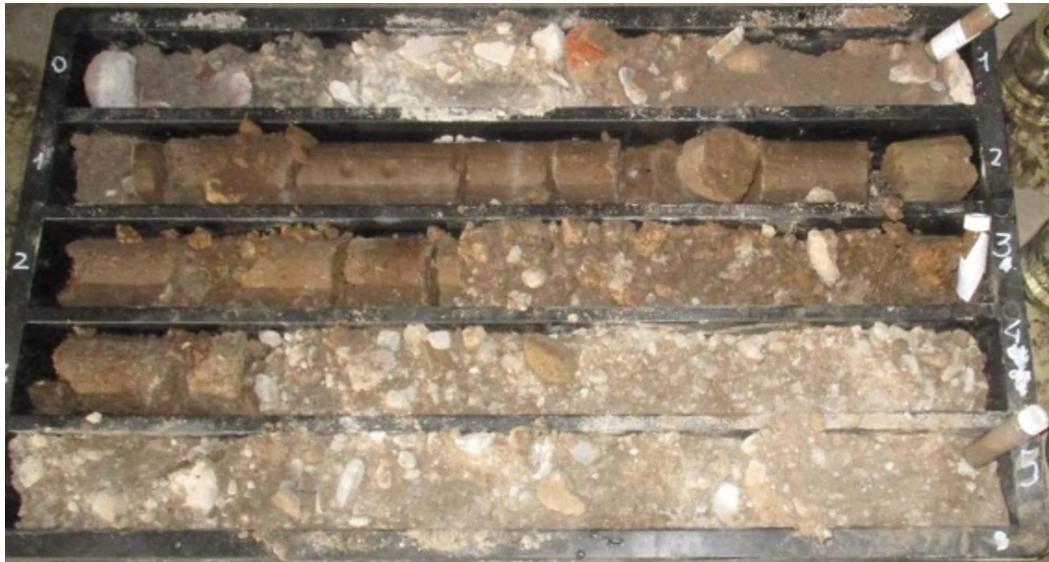
Immagine delle cassette catalogatrici – Carotaggio C12 da 0 a -5m (dal piano terra)
