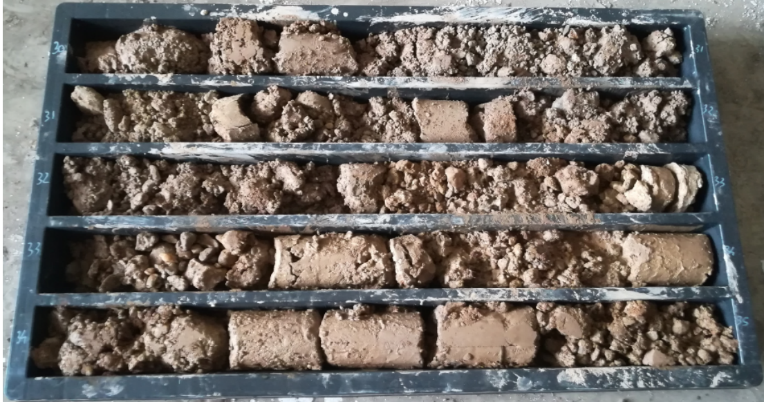
Immagine delle cassette catalogatrici – Sondaggio S3 da -30 a -35m
