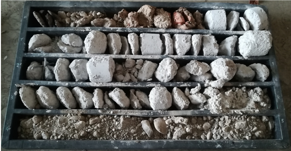
Immagine delle cassette catalogatrici – Sondaggio S3 da 0 a -5m
