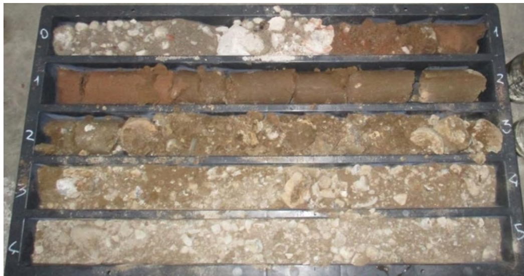
Immagine delle cassette catalogatrici – Carotaggio C11 da 0 a -5m (dal piano terra)
