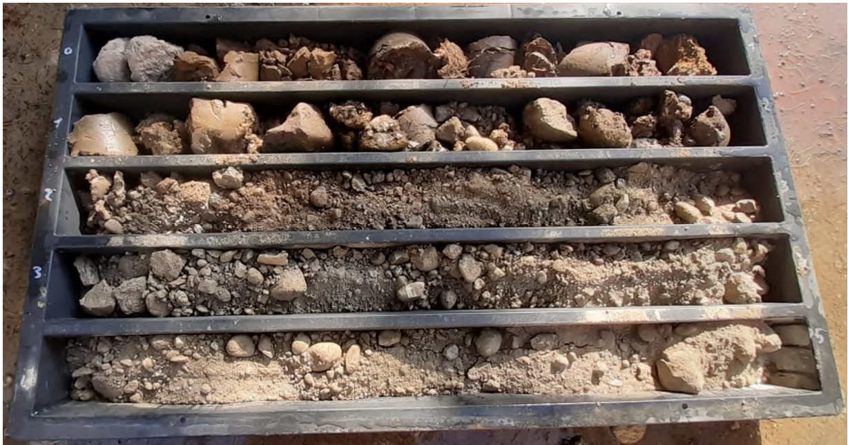
Immagine delle cassette catalogatrici – Sondaggio S2 da 0 a -5m
