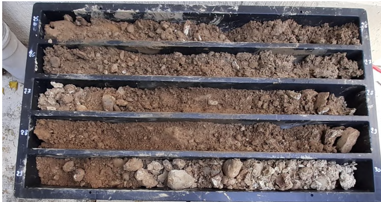
Immagine delle cassette catalogatrici – Sondaggio S1 da -25 a -30m
