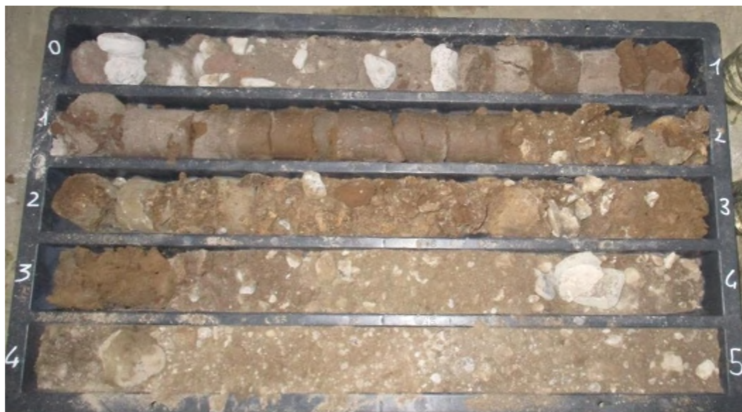
Immagine delle cassette catalogatrici – Carotaggio C13 da 0 a -5m (dal piano terra)
