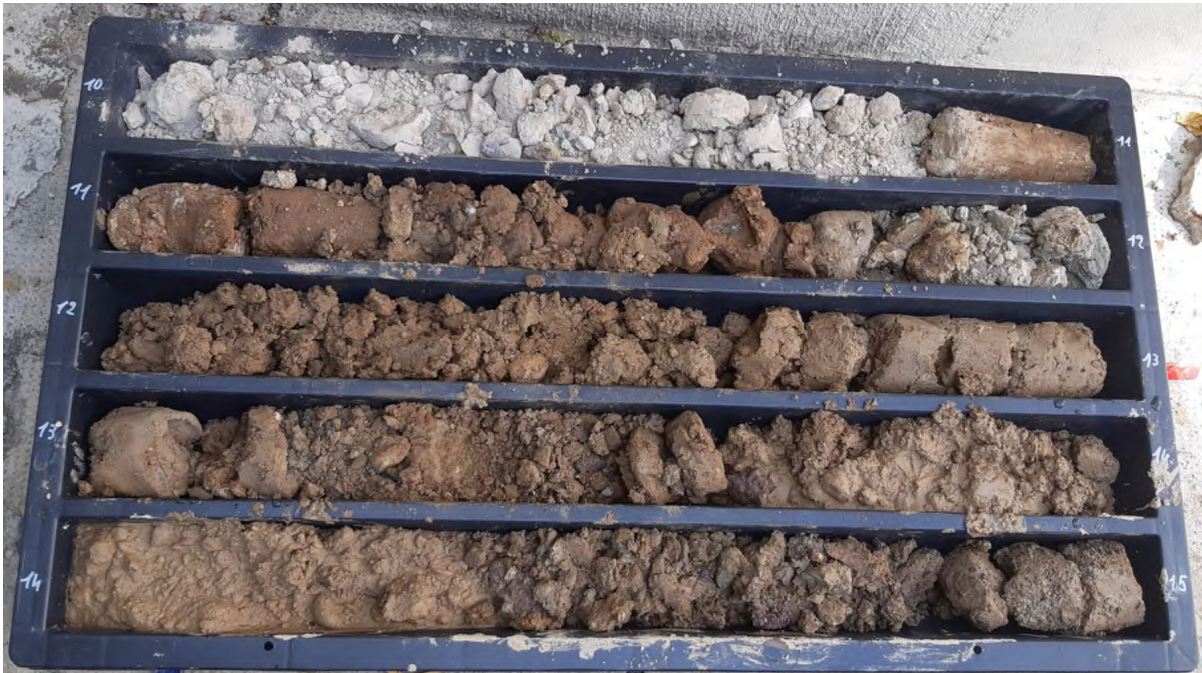
Immagine delle cassette catalogatrici – Sondaggio S1 da -10 a -15m
