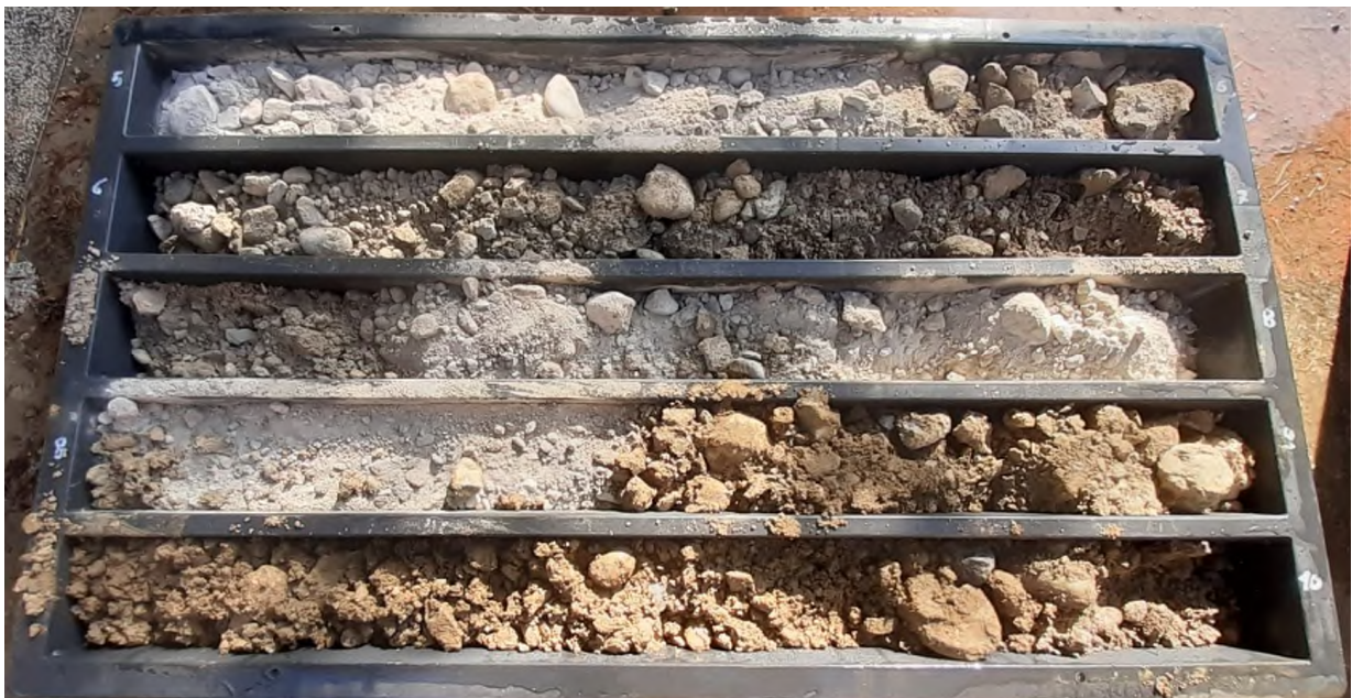
Immagine delle cassette catalogatrici – Sondaggio S2 da -5 a -10m
