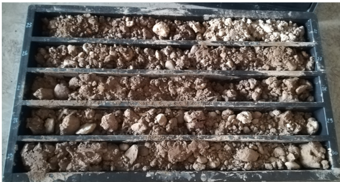
Immagine delle cassette catalogatrici – Sondaggio 3 da -25 a -30m
