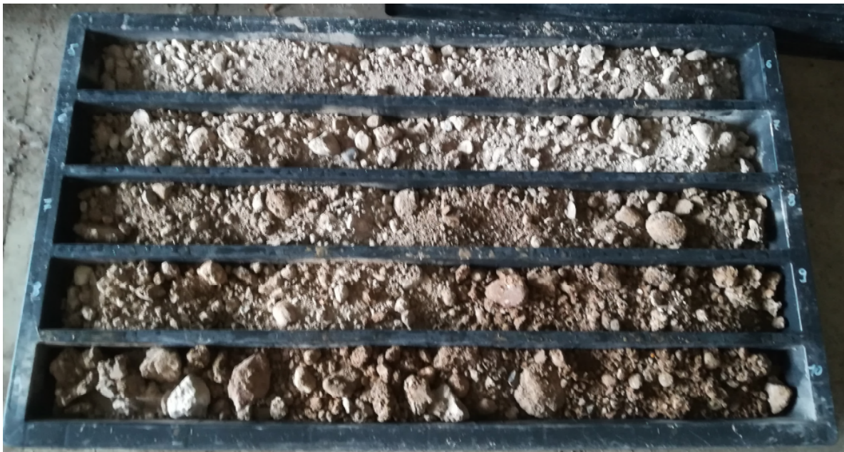
Immagine delle cassette catalogatrici – Sondaggio S3 da -5 a -10m
