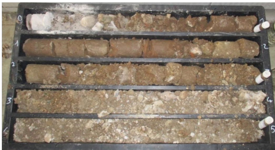
Immagine delle cassette catalogatrici – Carotaggio C15 da 0 a -5m (dal piano terra)
