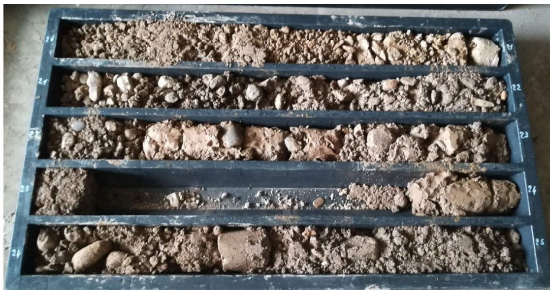
Immagine delle cassette catalogatrici – Sondaggio S3 da -20 a -25m
