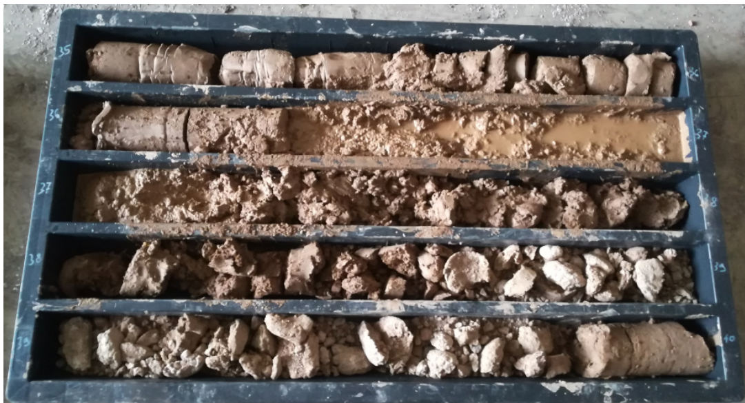
Immagine delle cassette catalogatrici – Sondaggio S3 da -35 a -40m
