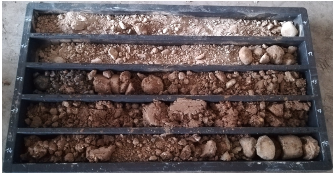
Immagine delle cassette catalogatrici – Sondaggio S3 da -10 a -15m
