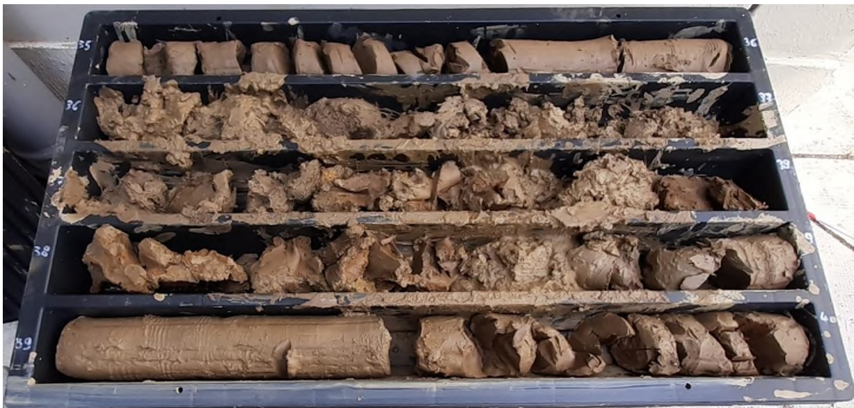
Immagine delle cassette catalogatrici – Sondaggio S1 da -35 a -40m
