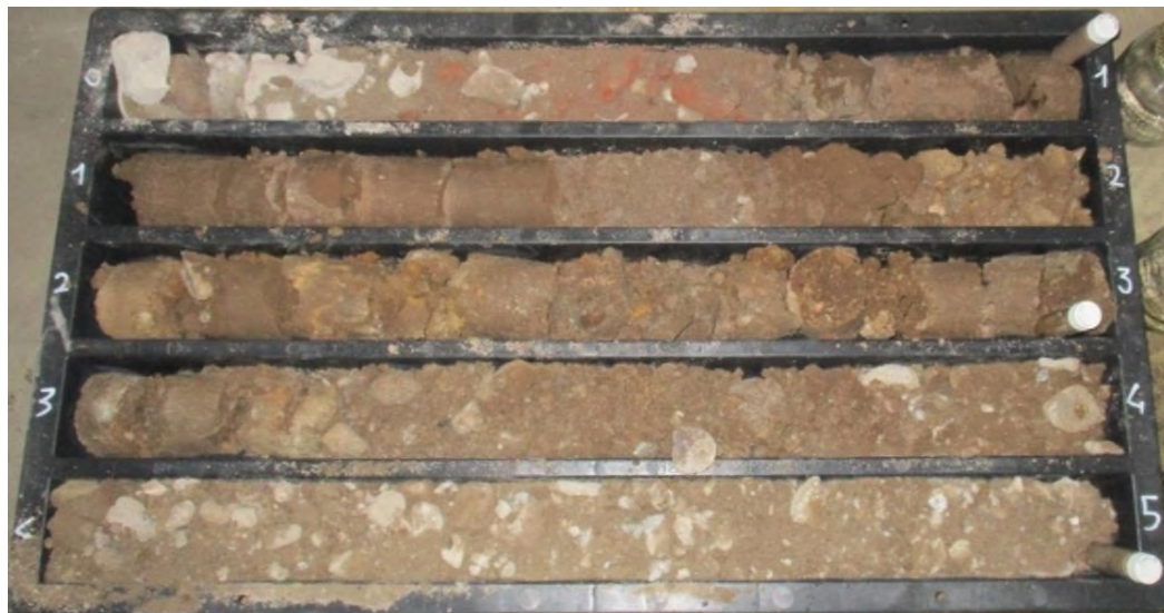
Immagine delle cassette catalogatrici – Carotaggio C14 da 0 a -5m (dal piano terra)
