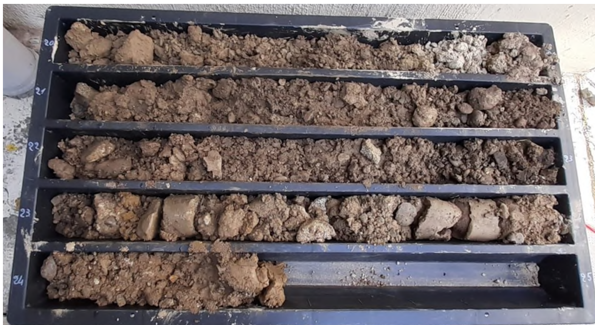
Immagine delle cassette catalogatrici – Sondaggio S1 da -20 a -25m
