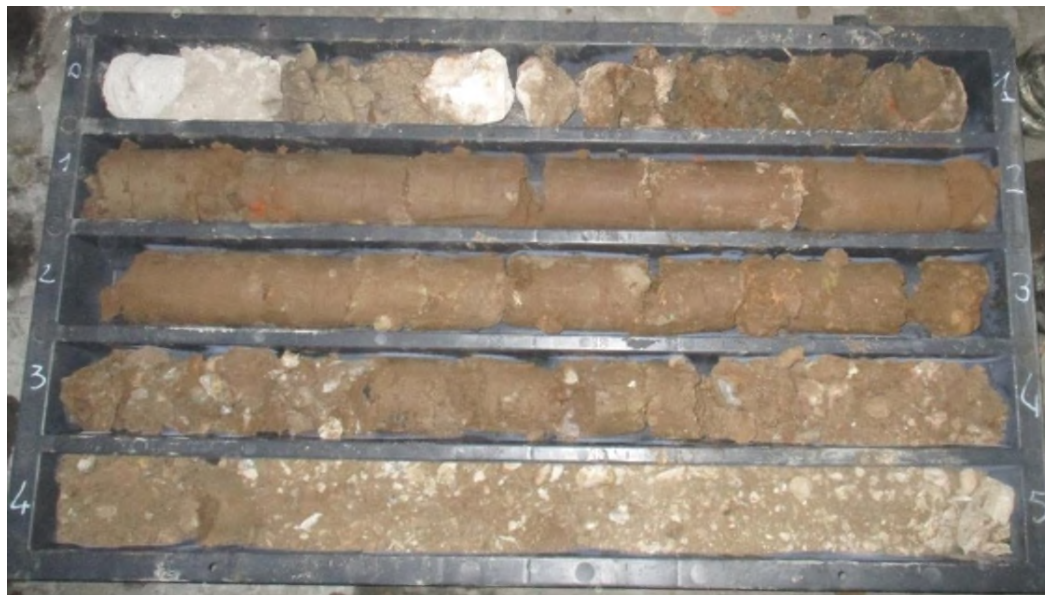
Immagine delle cassette catalogatrici – Carotaggio C8 da 0 a -5m (dal piano terra)
