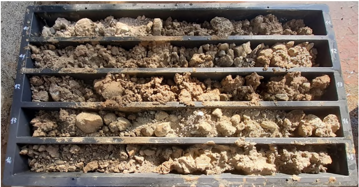
Immagine delle cassette catalogatrici – Sondaggio S2 da -10 a -15m
