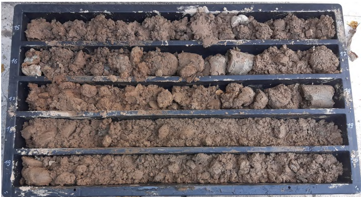
Immagine delle cassette catalogatrici – Sondaggio S1 da -15 a -20m
