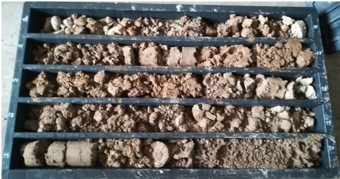
Immagine delle cassette catalogatrici – Sondaggio S3 da -15 a -20m
