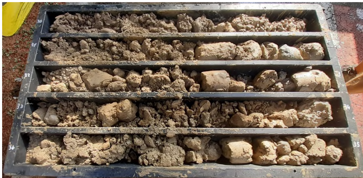
Immagine delle cassette catalogatrici – Sondaggio S2 da -30 a -35m
