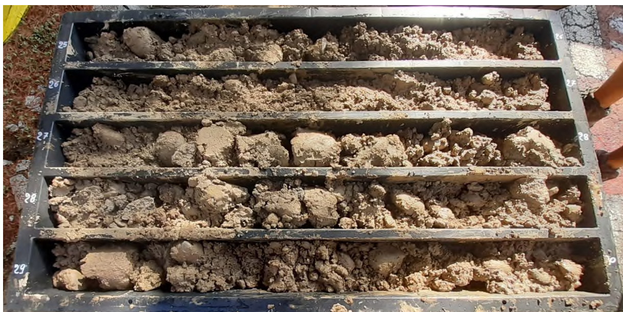
Immagine delle cassette catalogatrici – Sondaggio S2 da -25 a -30m
