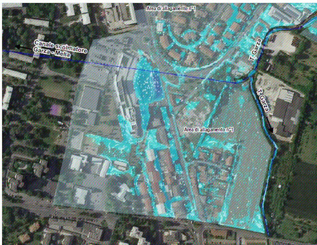
Figura n°4.5.6 - Flussi massimi nelle aree di allagamento n°01 a crocevia Nave
